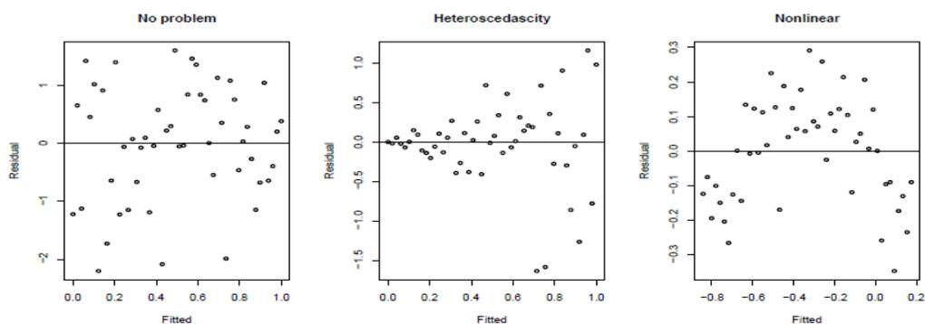
**Пример 4.** Графики для различных видов «проблем» регрессионных моделей. На первом графике нет проблем, на втором – проблема неоднородной дисперсии, на третьем – проблема нелинейности модели.
